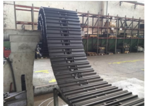
Figura 4 - Instalação das sapatas na corrente de rolamento
